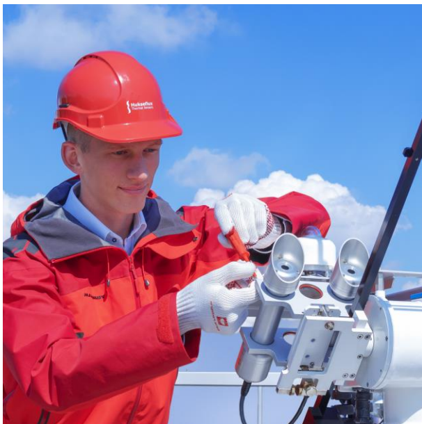
Figure 2 加热的重要性：安装在跟踪器上的加热型DR15-A1和DR20-A1直接辐射表的操作，这里安装的是加热型SR15-A1直接辐射表。由于朝露和霜冻的影响，几乎所有环境中非加热仪器的数据可用性都受到影响。
